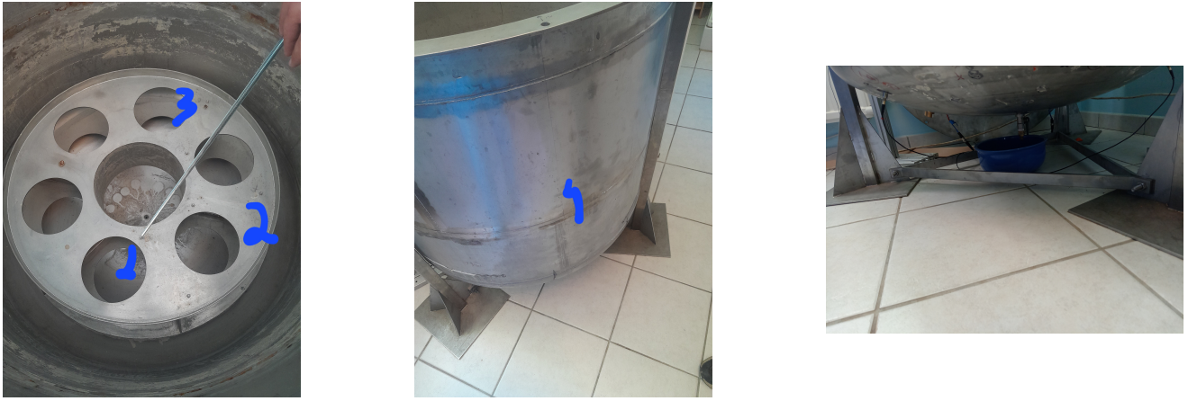
FIGURE 4.7 – Positions des points d'excitation, capteurs et transducteurs
