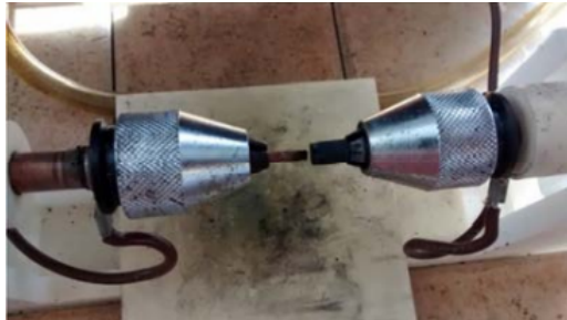
FIGURE 13 – Électrodes cuivre/carbone Source : Thèse [1]
