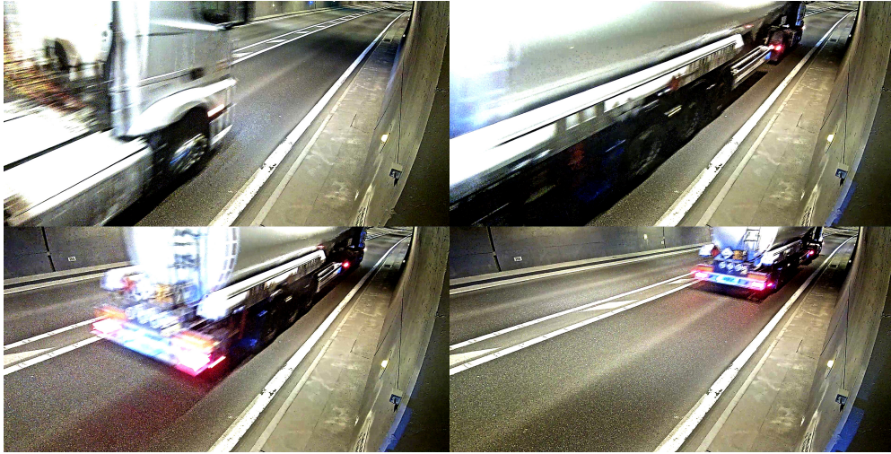
Figure 18 – Exemple d’images mettant en évidence le flou de bougé à l’intérieur du tunnel
