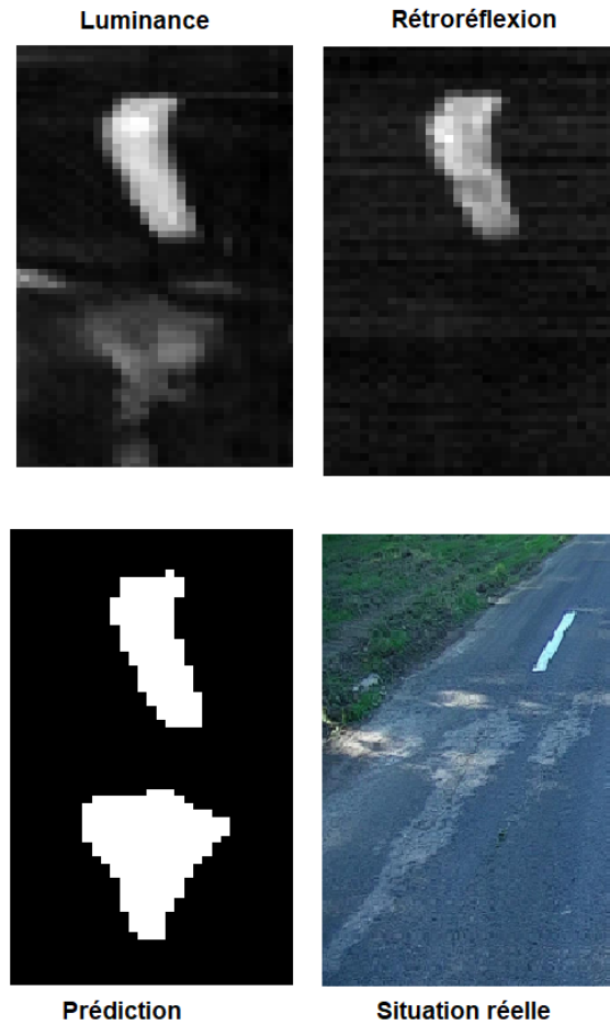
FIGURE 50 – Exemple de mauvaise segmentation .
