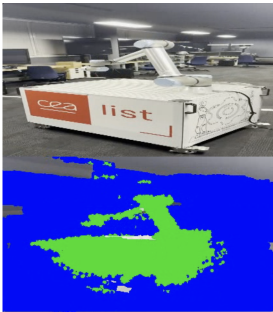
FIGURE 9 – Segmentation du mouvement (vert : pixels en mouvement, bleu : pixels immobiles)
